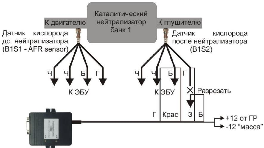
Эта схема включения предназначена для подключения к системам управления двигателем, имеющим передний широкополосный, четырехвыводной датчик состава смеси (AFRS). Для полного функционирования данной схемы, обязательно требуется рабочий задний датчик кислорода, который должен быть помещен (оставлен после удаления катализатора) в поток выхлопных газов.
