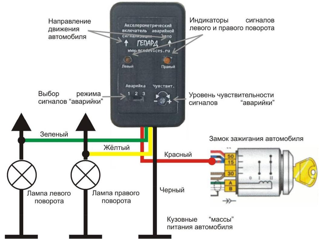
Плюс питания, красный провод прибора следует подключить к 15-й клемме замка зажигания – «включение зажигания».
